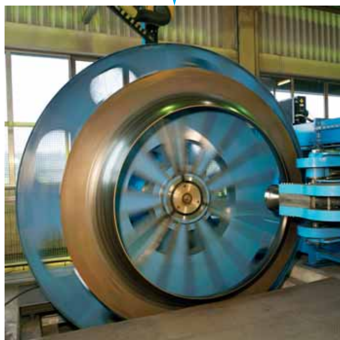
Изготовление защитных дисков рабочего колеса диаметром до 4,50 м на нашем обтяжном станке
