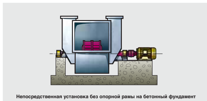
Рабочее колесо с двухсторонней подшипниковой опорой и соответствующей конфигурацией всасывания
